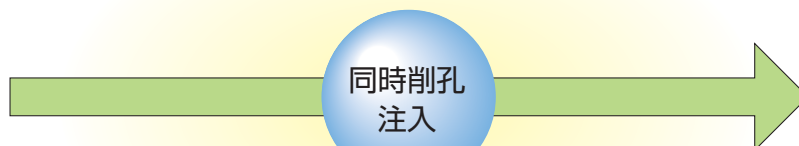
(削孔・芯材挿入・注入・ケーシング抜き)
