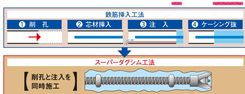
削孔とグラウト注入の同時施工により、大幅な工期短縮を実現します。補強材を強固に地山と一体化させる事で、道路の法面補強、表層の崩壊防止に最適です。
