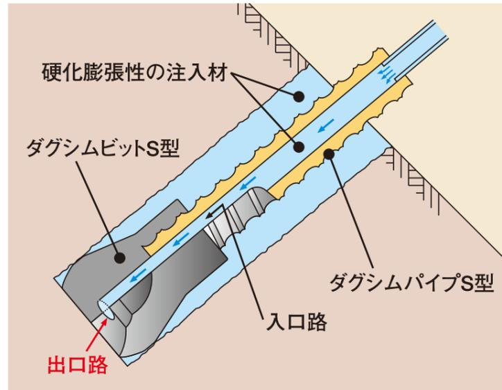
先端ビットで掘進すると同時に、ビットからセメントミルクを出し、瞬時に空隙を充填します。
